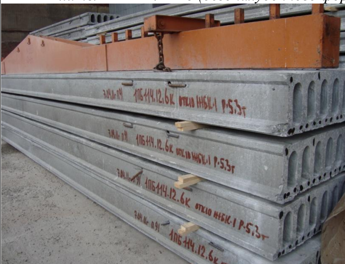
Плиты ППБ 114-12-8 (безопалубочного формования)
