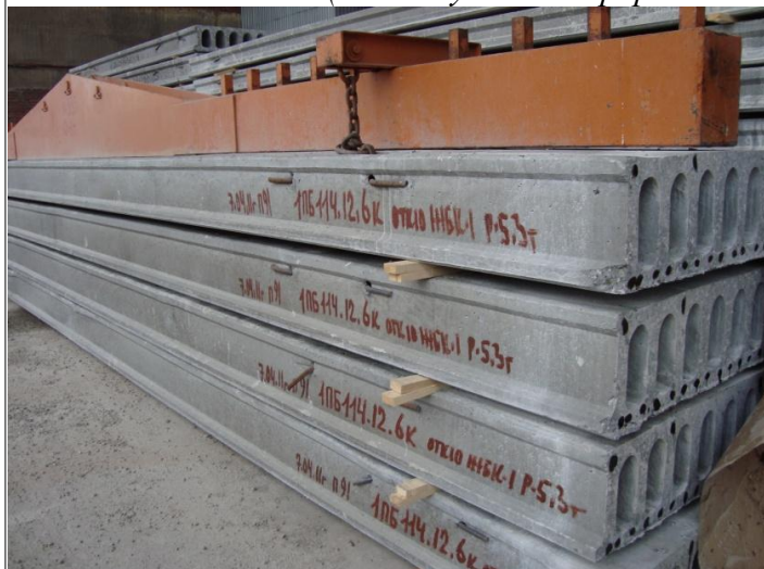
Плиты ППБ 114-12-8 (безопалубочного формования)
