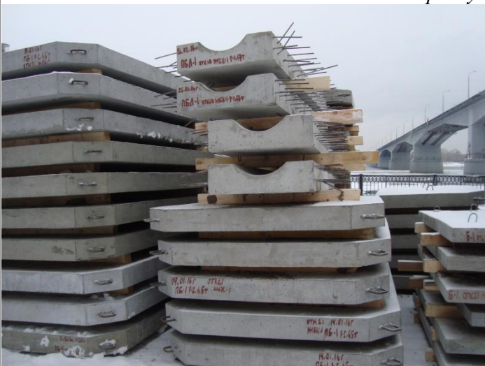
Плиты берегоукреплений ПБ и ПБл
